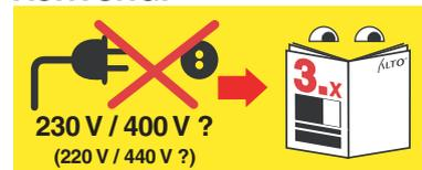
Bei Geräten mit **Spannungsumschaltung** unbedingt darauf achten, dass die korrekte Netzspannung am Gerät eingestellt ist, bevor der Netzstecker in die Steckdose gesteckt wird. Andernfalls können die elektrischen Bauteile des Gerätes zerstört werden.
